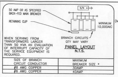
\* SIZE BASED ON ENSURING BREAKER WILL TRIP ON FAULTS AT END OF LONG CIRCUITS.
