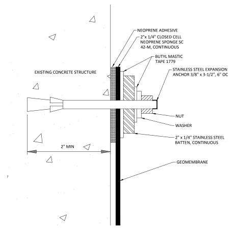
4 TYPICAL BATTEN STRIP CONNECTION FOR FLARE STATION PAD
